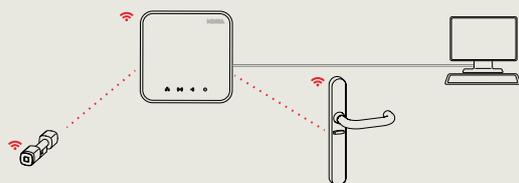
Das Wireless Gateway 90 40 ist per Funk mit den Zutrittskomponenten verbunden und per Ethernetkabel mit dem Zutrittssystem.
